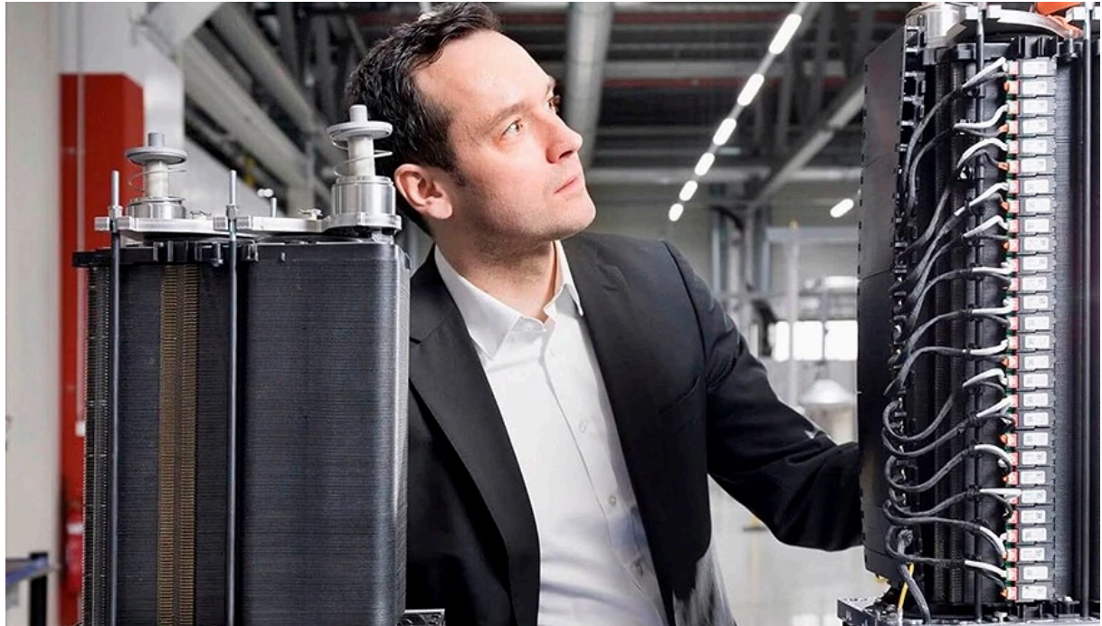
En una pila de combustible se apilan alternativamente hasta 400 placas bipolares con sistemas de membranas.
