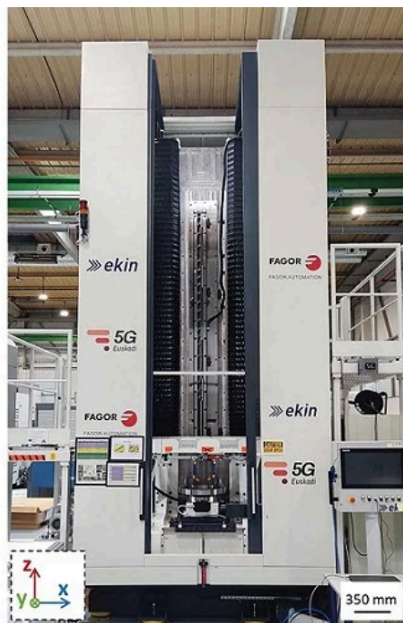
Figura 2. Brochadora electromecánica Ekin A218 utilizada como caso de uso.
